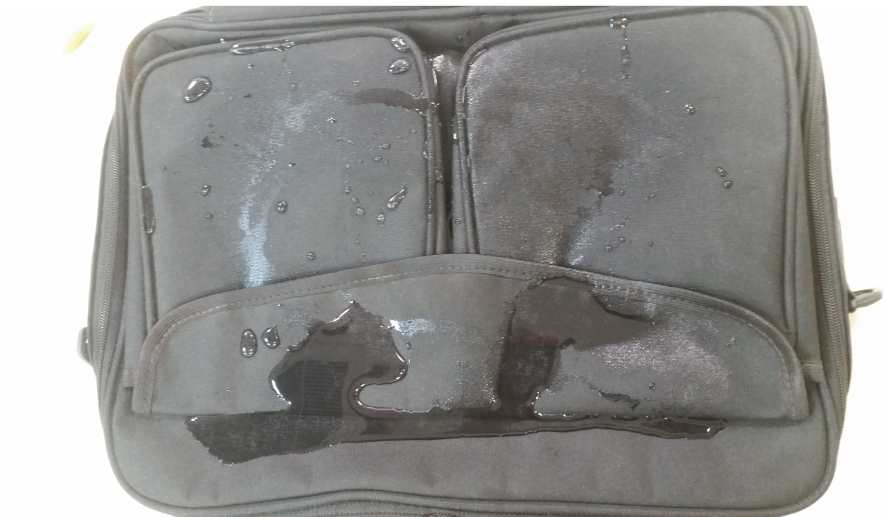
Foto 11: Laptop - Teste de impermeabilidade
