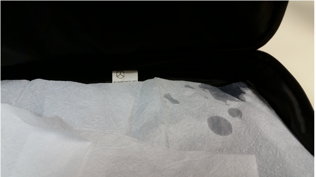
Foto 12: Laptop - Papel no interior molhado após teste de impermeabilidade
