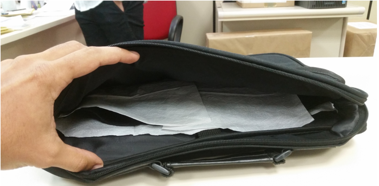
Foto 10: Laptop - Papel colocado antes do teste de impermeabilidade
